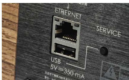
LAN to najpewniejsze połączenie sieciowe, USB służy wyłącznie do zadań serwisowych.
